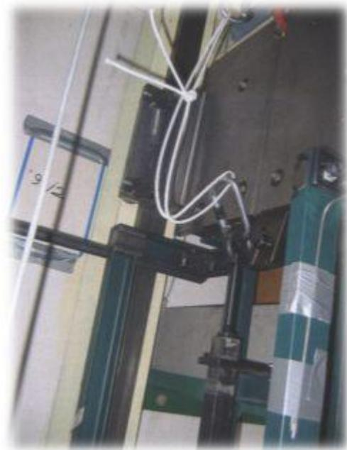
*Test en facteur de chute 0,2 d'un anneau fermé par un noeud de vache plein poing*
