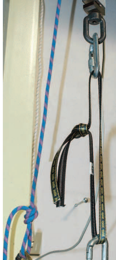
Photographies 3: Test nœud de 8 plein poing à l'ENSA.
